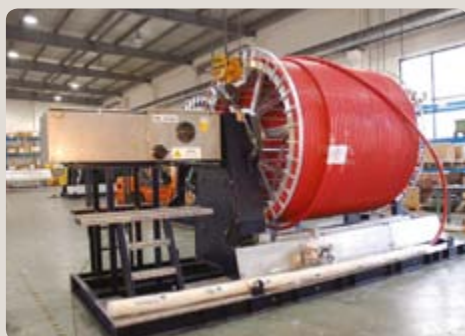
Horisontella bredspolande kabelvindor för användning i en gruva färdiga för leverans
