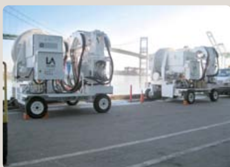
Färjeterminaler vid Port of Los Angeles använder mobila AMP-system för många inkommande fartyg
