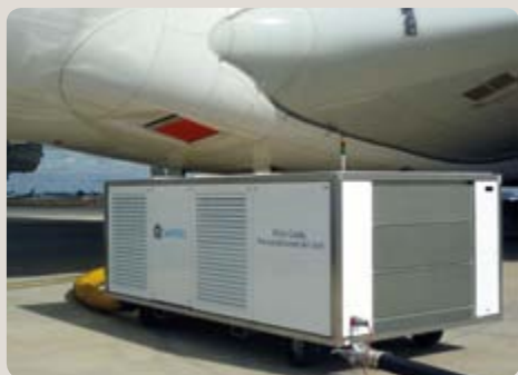
Även i varmt klimat fortsätter PCAir-systemet att leverera nedkylt konditionerad luft
